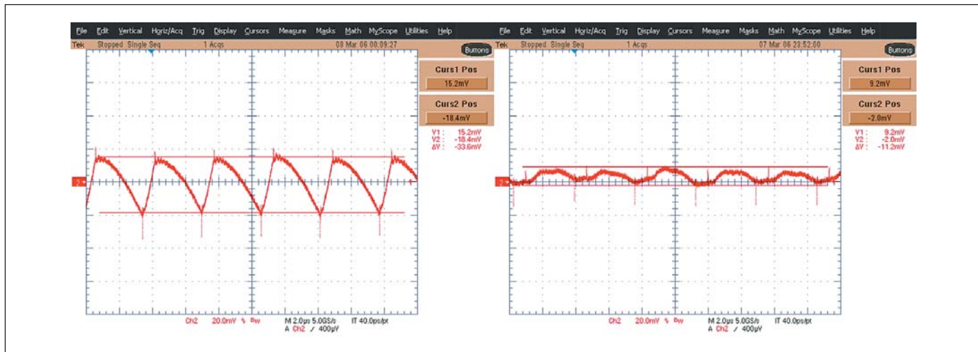
Рис. 7. Графики пульсаций: а) в обычном режиме; б) в режиме Emulated Ripple Mode
