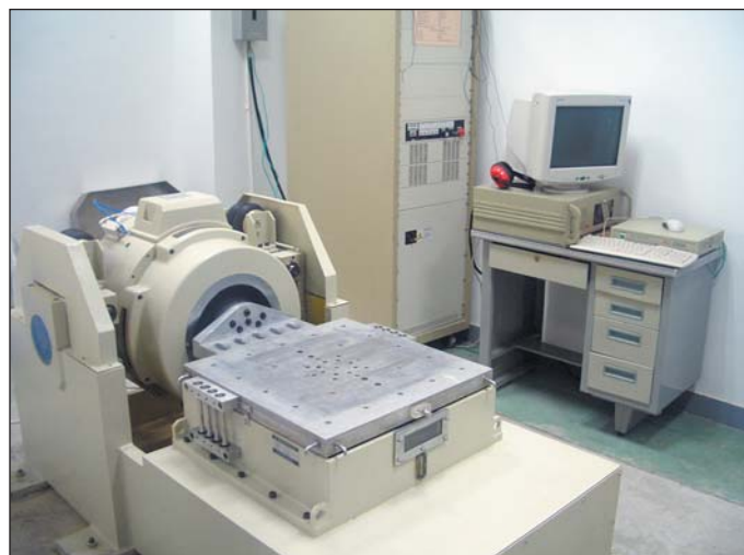
Рис. 6. Испытания на виброустойчивость
